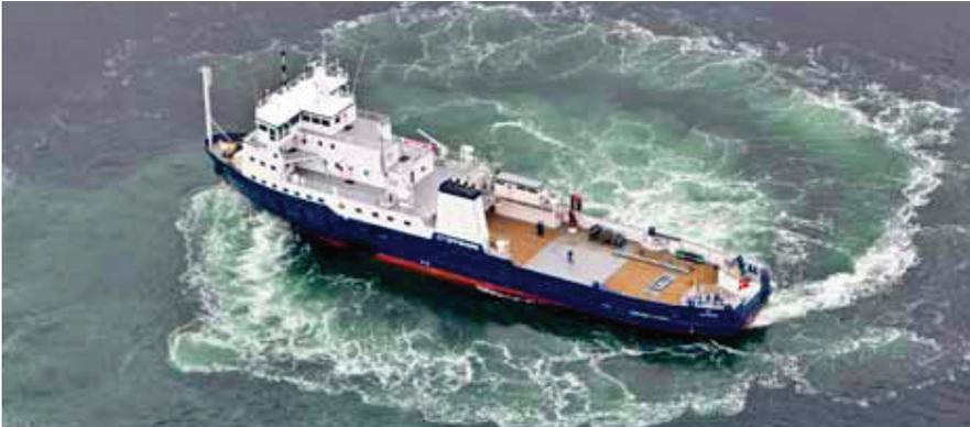
Новая динамическая система позиционирования с электрическими туннельными подруливающими устройствами способна удерживать такое судно как SIA на месте с точностью 200 мм.
