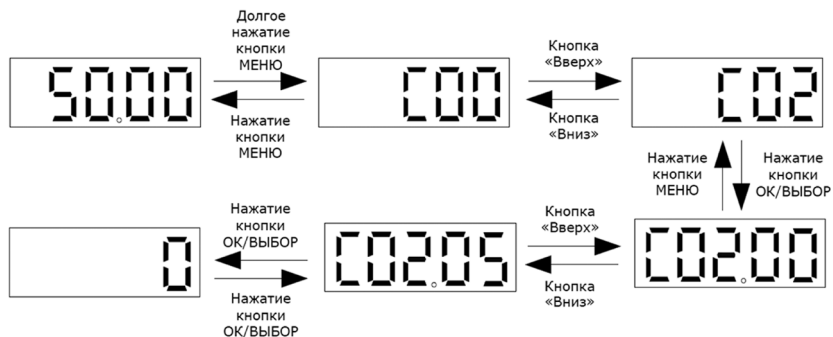
Рисунок 5.5-3. – Основные операции с панелью управления
