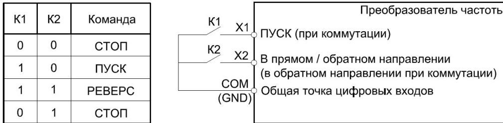
Рисунок 8.8-2 – Двухпроводная схема управления 2
