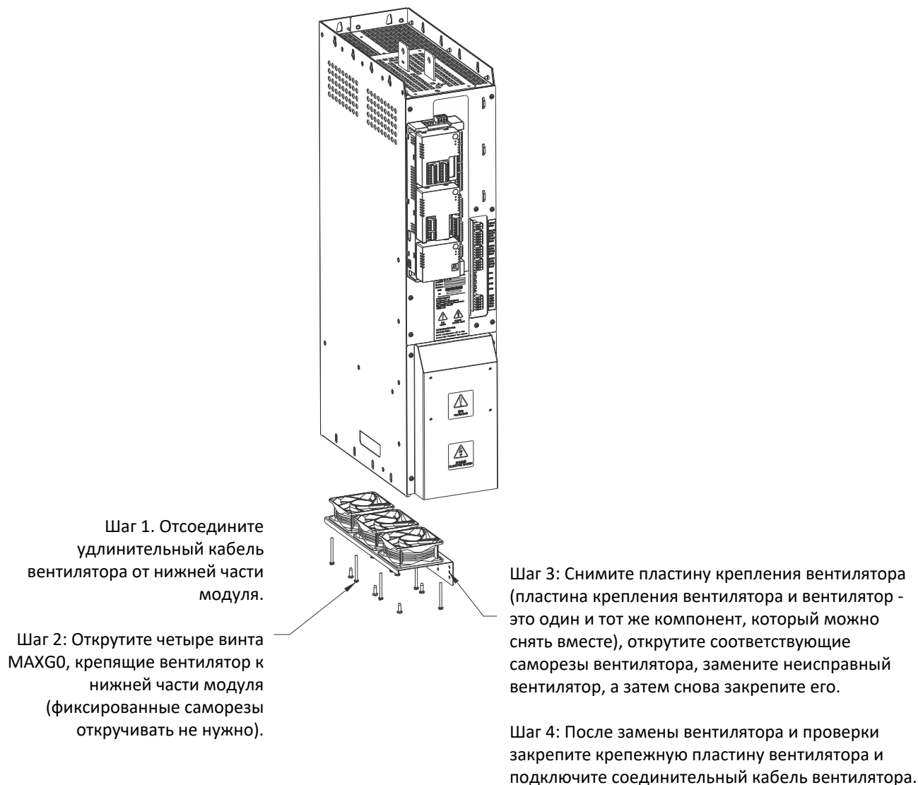
Рис. 7-2 Замена вентилятора модуля FR6
