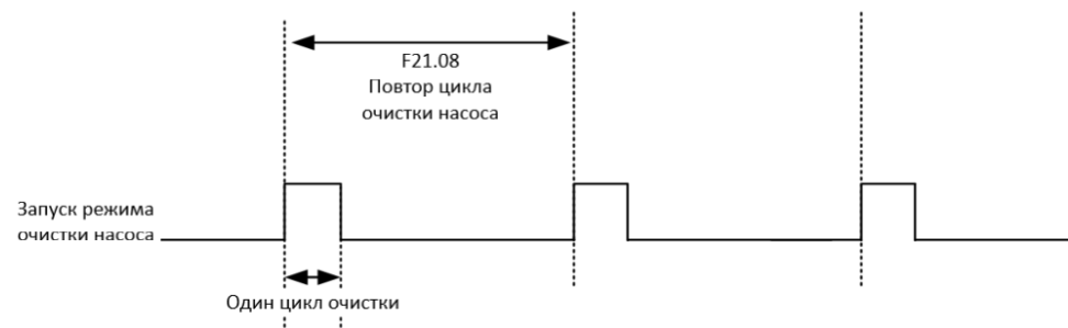
Рисунок 9 – Режим очистки насоса при автоматическом управлении (по времени)
