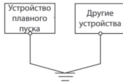
Рис. 3-8б. Схема заземления
