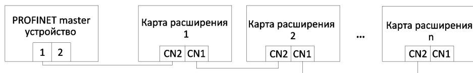
Рис. 4.1. Последовательное соединение шины Profinet
