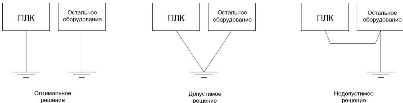
Рис. 5.3 Заземление ПЛК
