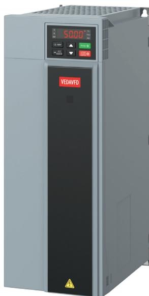
**Серия VF-101** — преобразователи частоты для систем отопления, вентиляции и кондиционирования, а также насосов, общепромышленных применений, в том числе с тяжелыми пусками. Привод предназначен для работы в сетях питания 1x220В, 3x380В, 3x660В, 3x1140В и мощностью от 0,75 до 1120 кВт, возможно исполнение с нормальной и высокой перегрузкой. Привод имеет встроенный сетевой интерфейс RS-485. Частотный преобразователь VF-101 может управлять асинхронными и синхронными двигателями.
