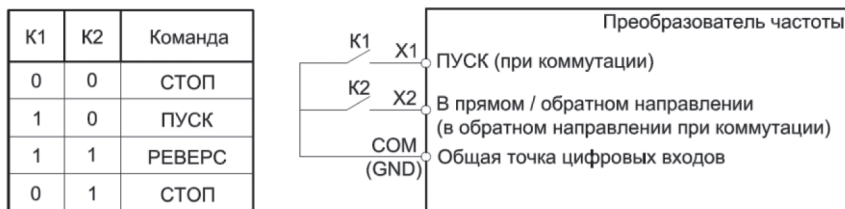
Рисунок 10.9-6. – Двухпроводная схема управления 2
