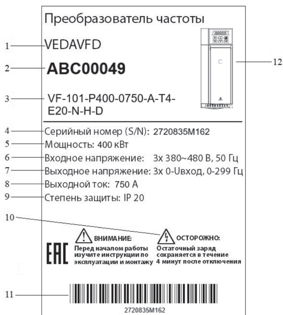
Рисунок 1.3-1 – Пример маркировки преобразователя частоты
