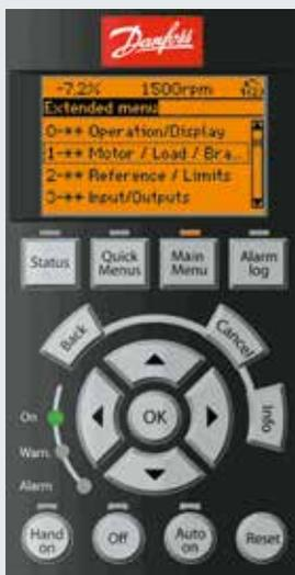
Приводы VLT® и VACON® оснащены удобной в использовании, подключаемой без приостановки работы панелью местного управления (LCP) для легкой настройки и конфигурации параметров.
