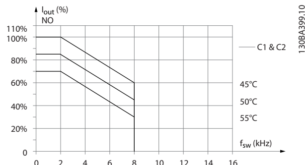
Рисунок 5.17 Снижение I_{\text{вых.}} при различных значениях T_{\text{окр.}} ср., МАКС. для корпусов размера C1 и C2, при использовании модели коммутации SFAVM в режиме нормальной перегрузки (крутящий момент 110 %)
