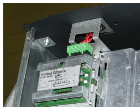
Рисунок 3.53: Подключение шины сети fieldbus сверху.
