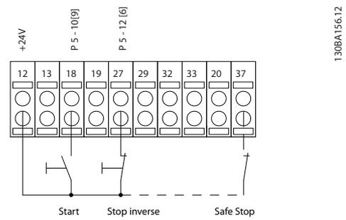
Illustration 4.21 Wiring Pulse Start/Stop
