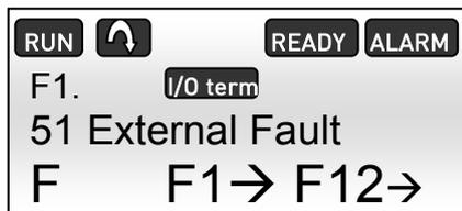
Рисунок 5.1-5, Аварийный сигнал наличия протечки на панели NXP
