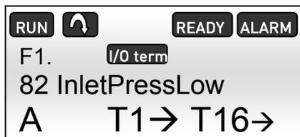
Рисунок 5.1-4, Аварийный сигнал при понижении давления на панели NXP
