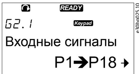
4. С помощью кнопок «вверх» и «вниз» перейдите к параметру (P#), который нужно изменить. Дойдя до самого последнего параметра группы параметров, можно перейти непосредственно к первому параметру группы, нажав кнопку «вверх».
