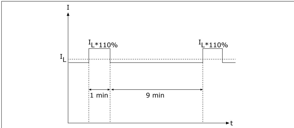
Рис. 26: Небольшая перегрузка
