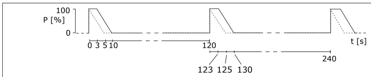
Рис. 29: Рабочие циклы импульсов LD и HD
