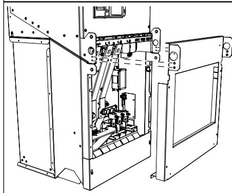
2 Найдите электромагнитную перемычку между клеммами L2 и L3.
