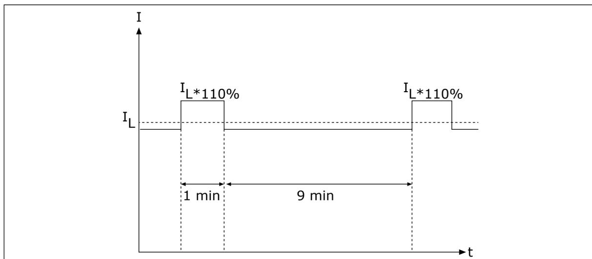
Рис. 30: Низкая перегрузка в Vacon® 100 FLOW
