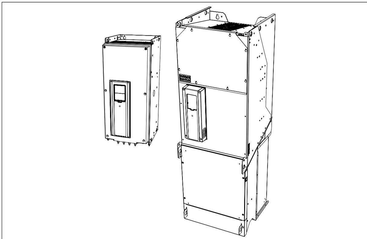
Рис. 1: Примеры приводного модуля Vacon 100 IP00
