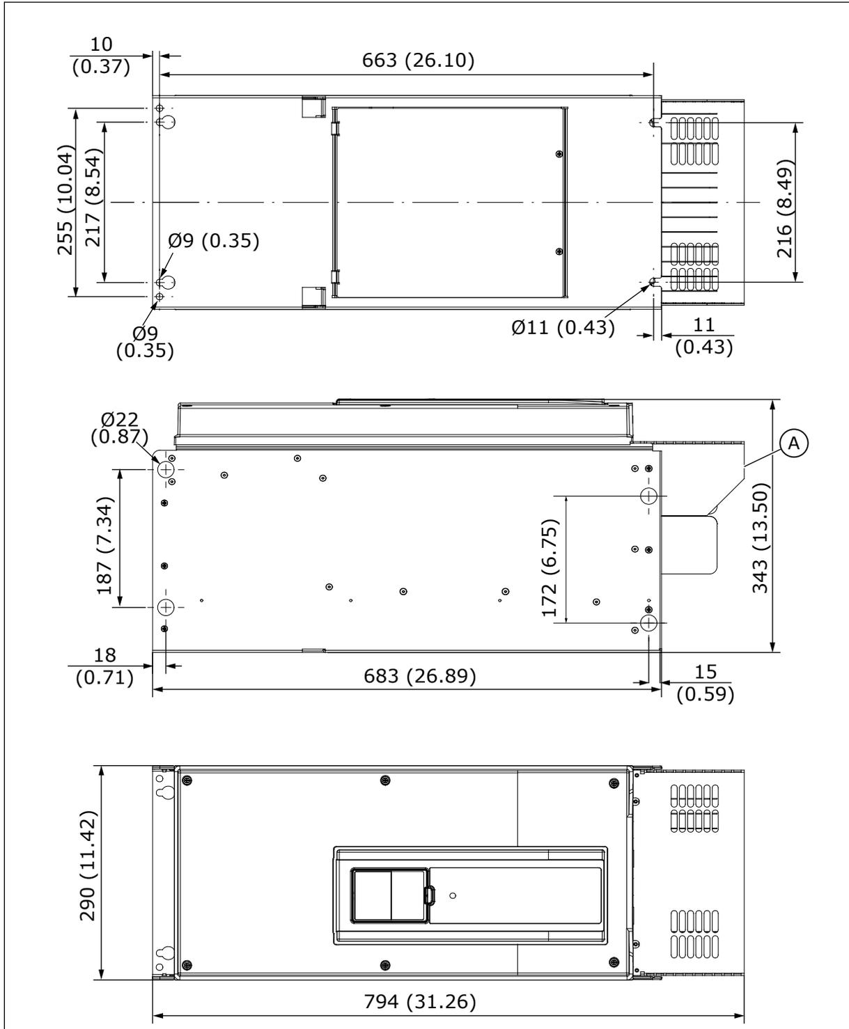
Рис. 3: Габариты преобразователя частоты MR8 [мм (дюймы)]
