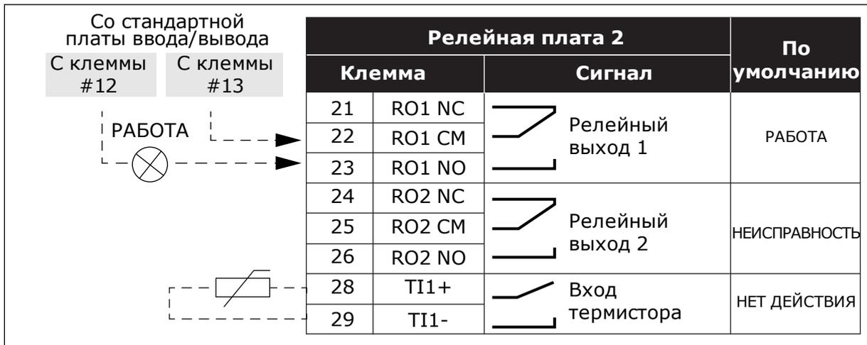
Рис. 21: Дополнительная релейная плата (+SBF4)
