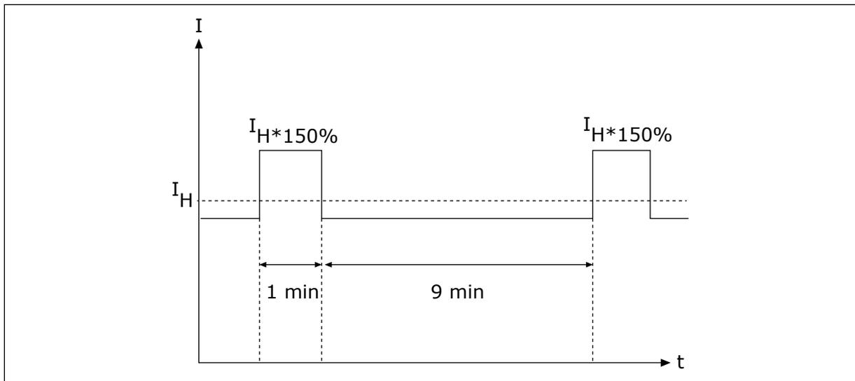
Рис. 27: Большая перегрузка
