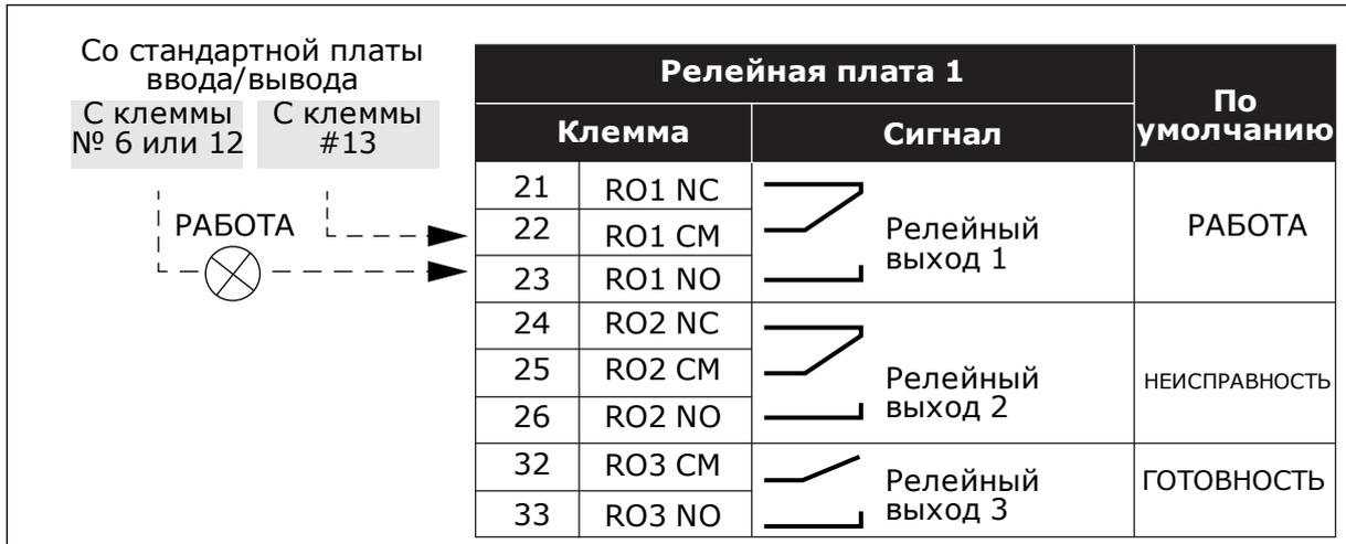
Рис. 20: Стандартная релейная плата (+SBF3)
