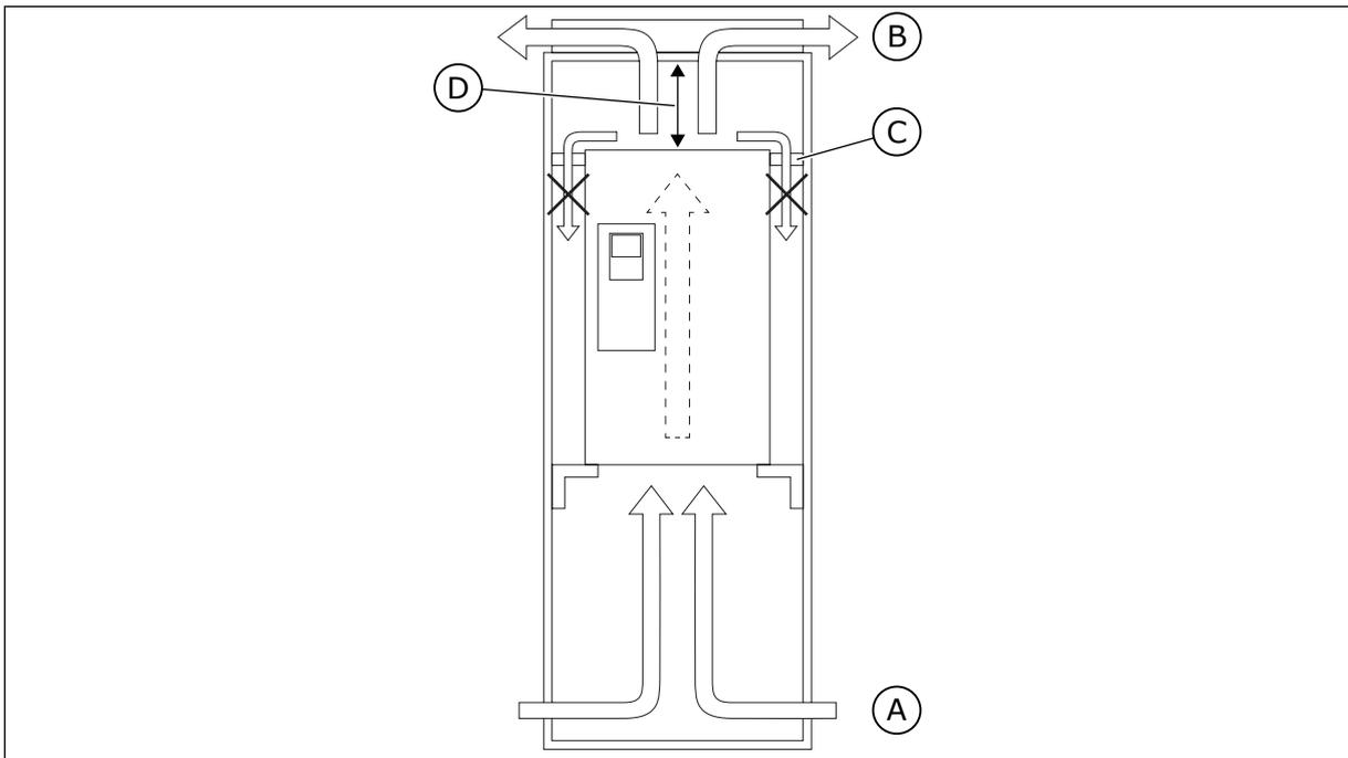
Рис. 14: Правильная циркуляция охлаждающего воздуха внутри шкафа.
