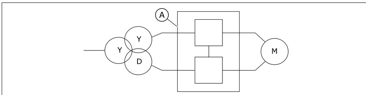
Рис. 13: 12-импульсная работа MR12
