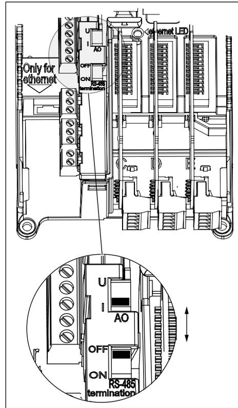
5 Окончание шины должно устанавливаться для первого и последнего устройства шины fieldbus. Рекомендуется, чтобы первое устройство на шине fieldbus было управляющим устройством.
