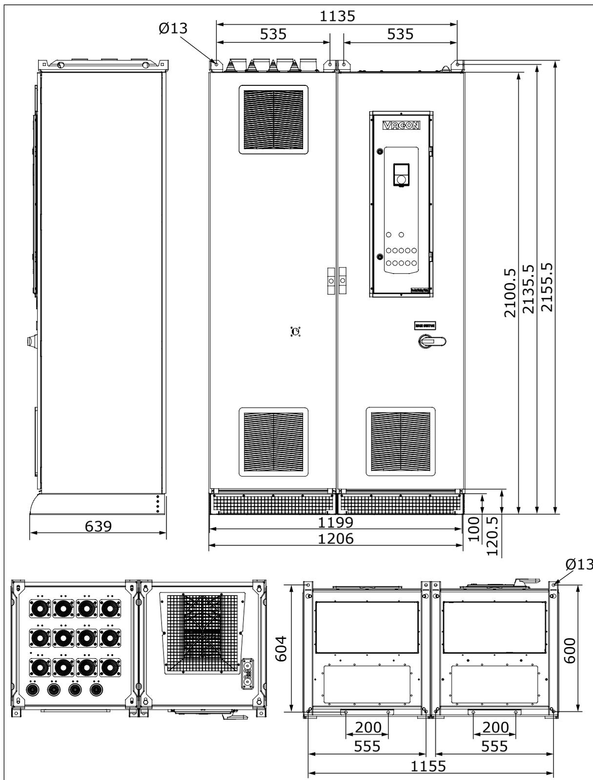
Рис. 7: Габариты шкафа с дополнительными кабелями сверху и входным контактором, MR10 с мин. 416 А, [мм], IEC. См. Табл. 5.
