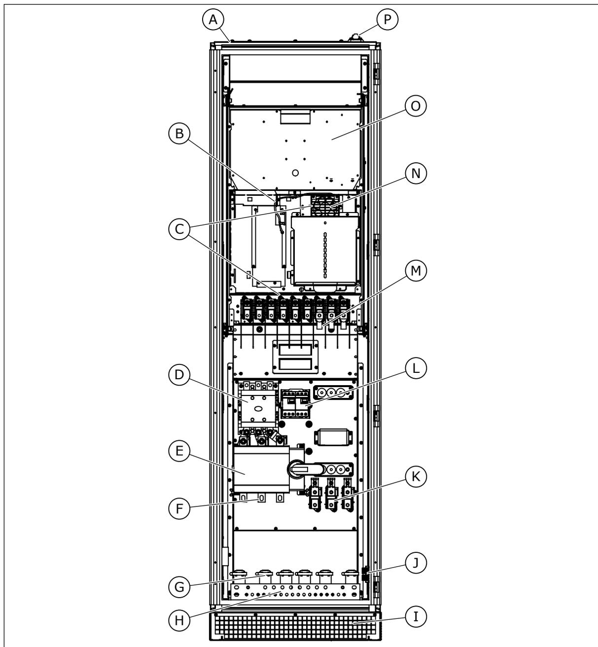
Рис. 36: Внутренняя прокладка MR9, без защитных крышек
