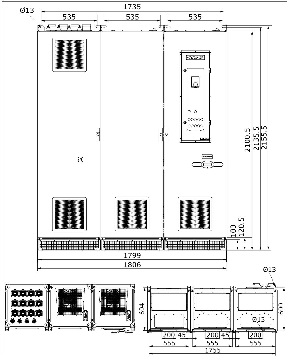
Рис. 8: Габариты шкафа с дополнительными кабелями сверху и(или) входным контактором, MR12, [мм], IEC
