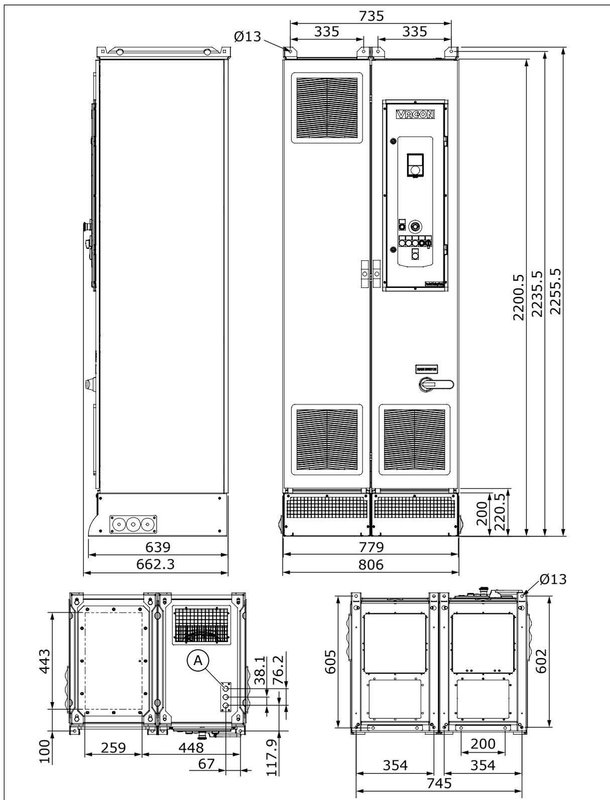
Рис. 13: Габариты шкафа с дополнительными кабелями сверху, MR8, [мм], NAM
