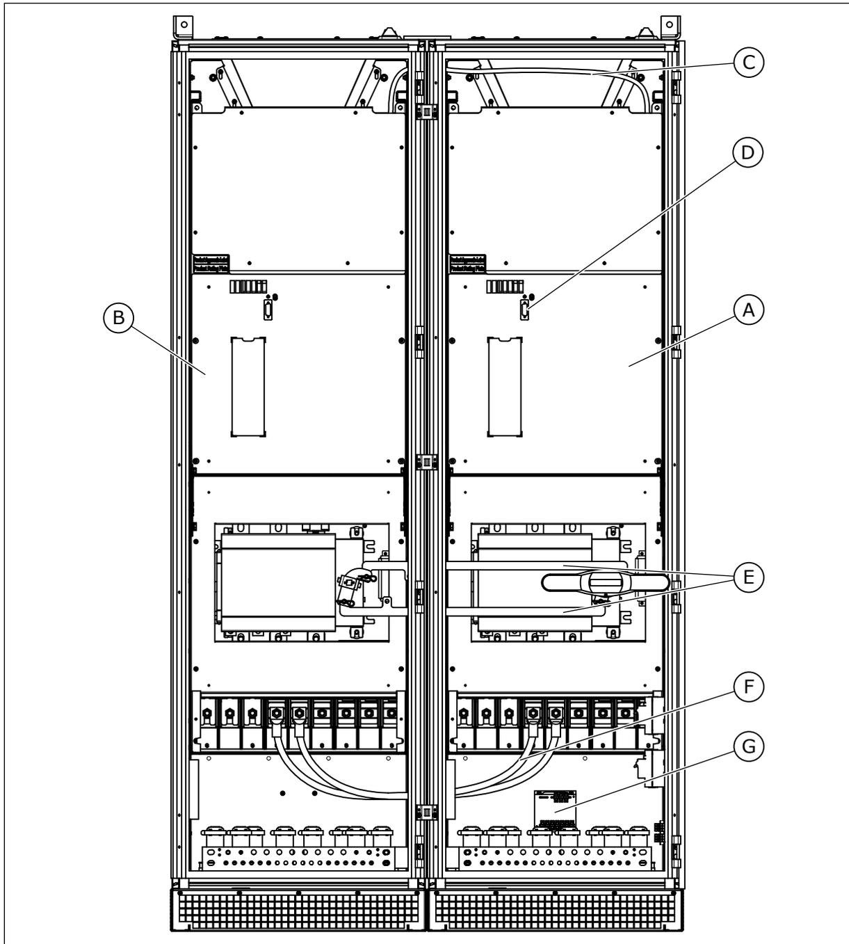
Рис. 38: Внутренняя прокладка MR12, без защитных крышек
