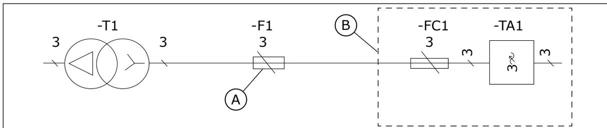
Рис. 33: Расположение предохранителей, MR8–MR10
