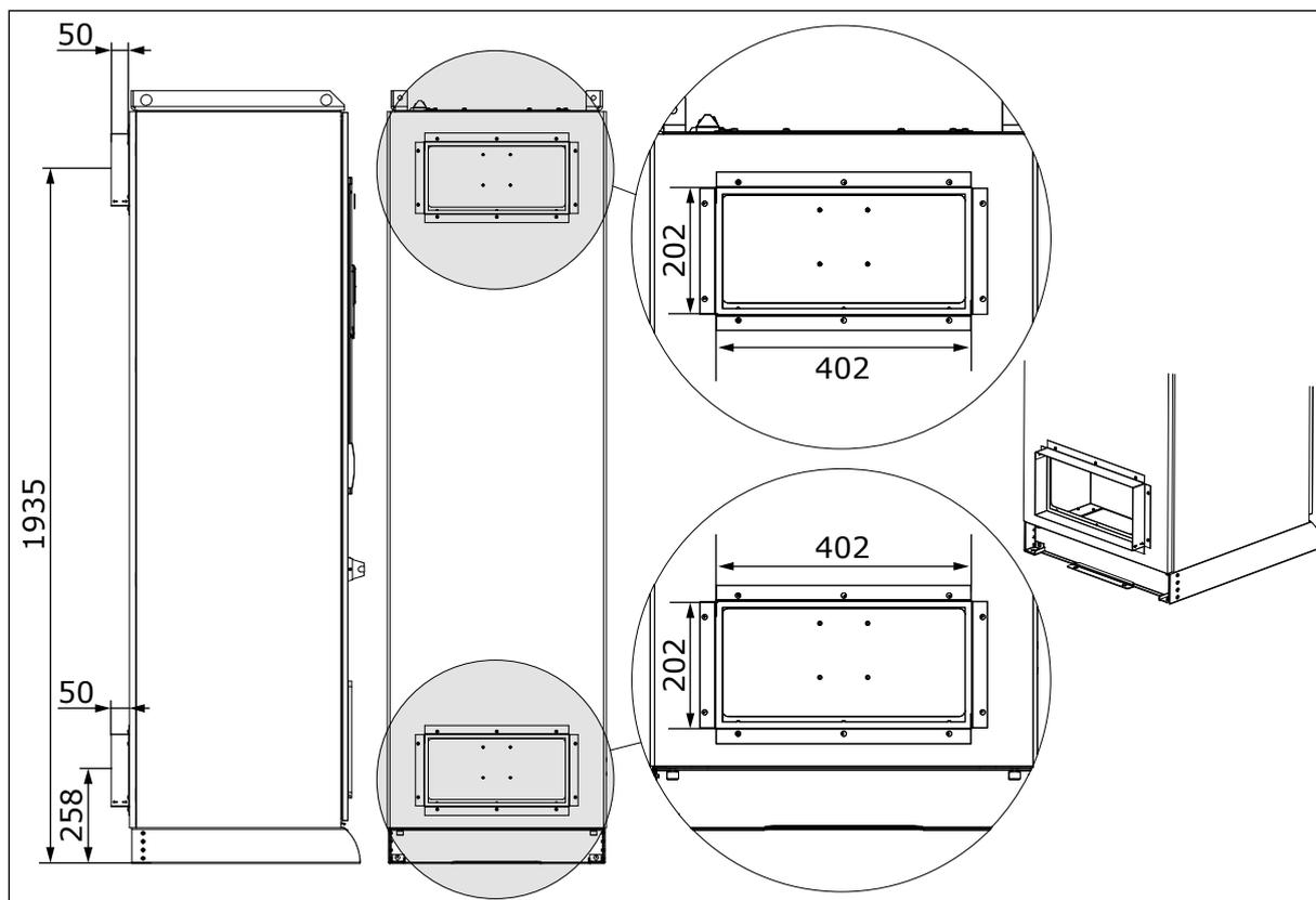
Рис. 27: Габариты охлаждения по обратному каналу, MR9 и MR10
