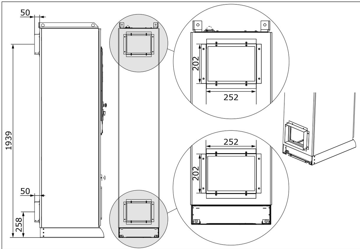
Рис. 26: Габариты охлаждения по обратному каналу, MR8
