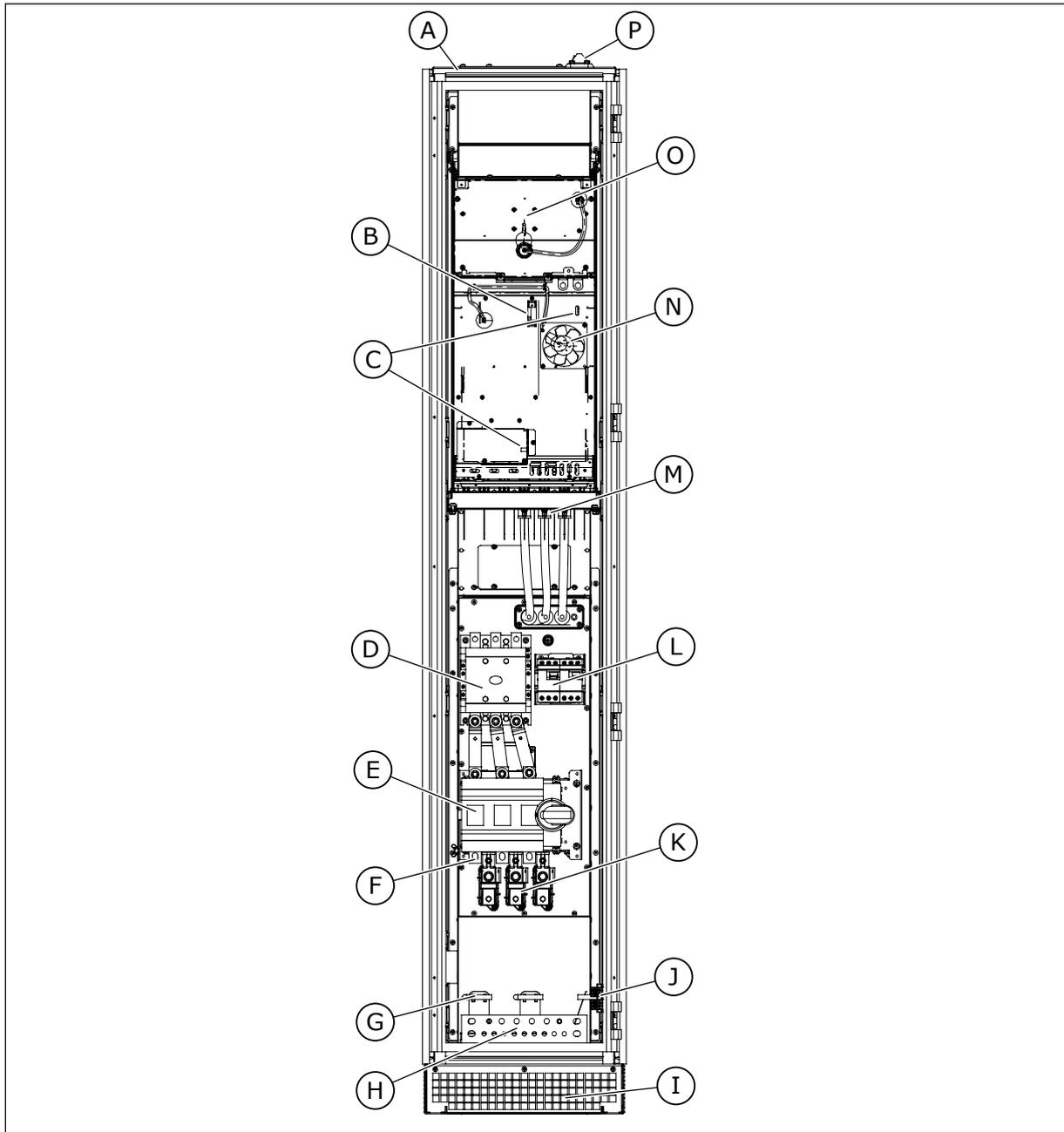
Рис. 35: Внутренняя прокладка MR8, без защитных крышек
