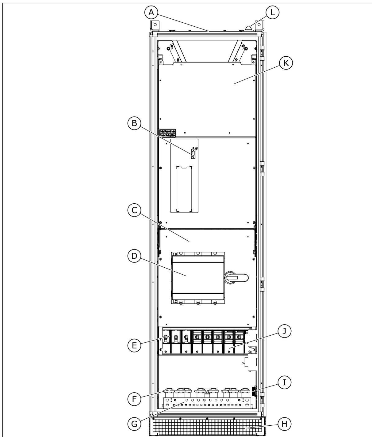
Рис. 37: Внутренняя прокладка MR10, без защитных крышек
