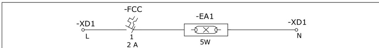
Рис. 19: Освещение шкафа
