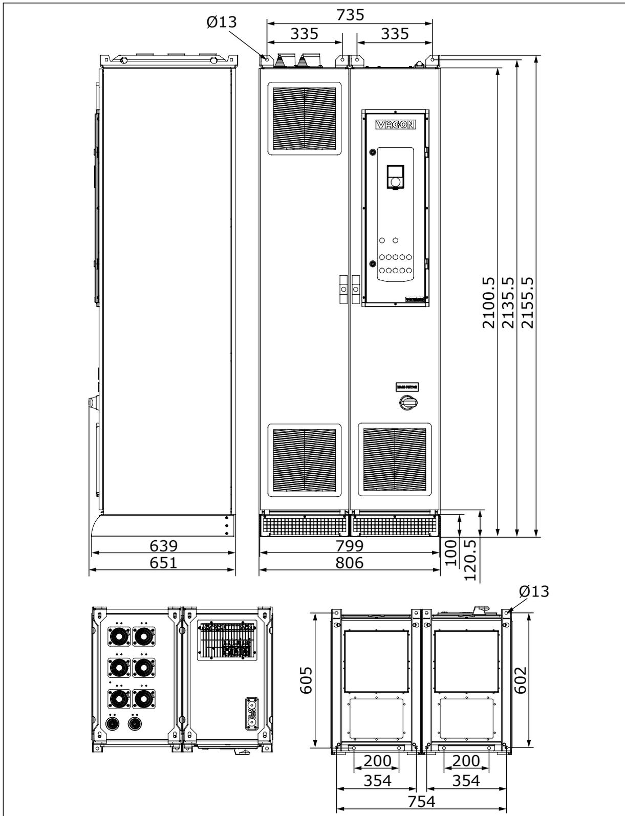
Рис. 6: Габариты шкафа с дополнительными кабелями сверху, MR8, [мм], IEC
