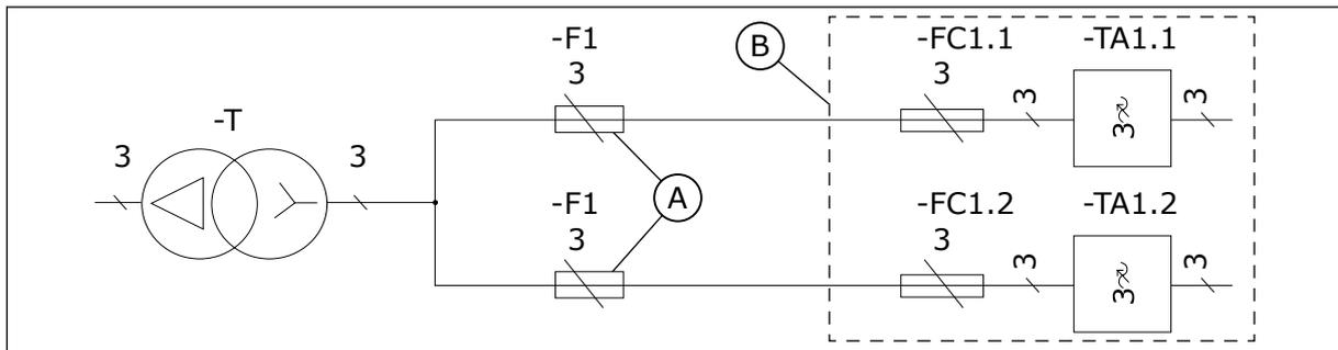
Рис. 32: Расположение предохранителей, MR12
