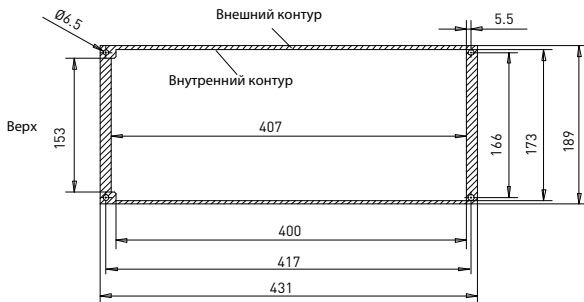
Рис. 6: Размеры выреза для фланцевого крепления приводов типоразмеров M15 (единица: мм)
