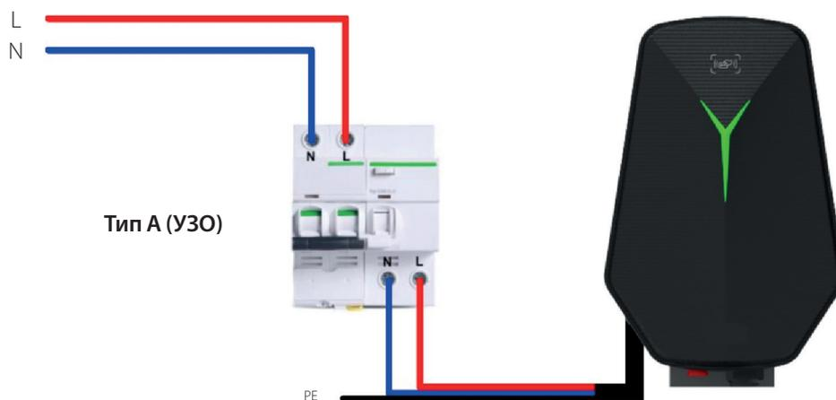
Чертеж автоматического выключателя за пределами зарядного устройства для электромобилей мощностью 7 кВт переменного тока
