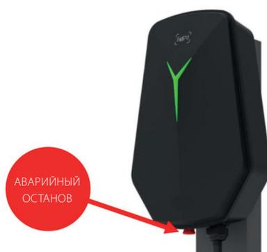
Восстановление после аварийного останова: после устранения аварийной ситуации поверните кнопку аварийного останова по часовой стрелке, и зарядное устройство вернется в режим ожидания после отпускания кнопки.
