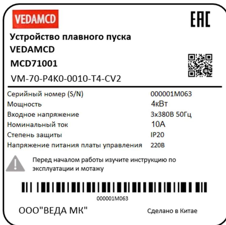
Рисунок 1. Пример маркировки устройства плавного пуска
