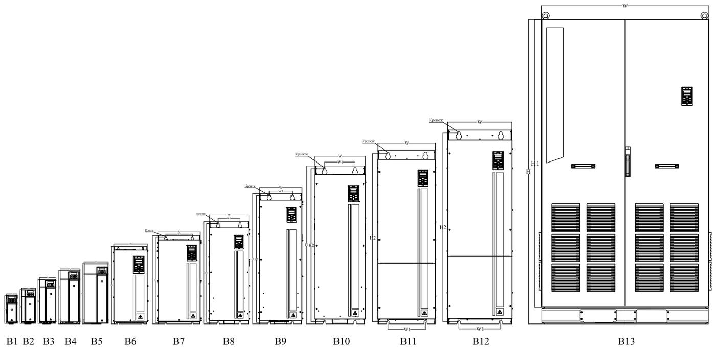
Рисунок 2.1-1 Типоразмеры преобразователей частоты
