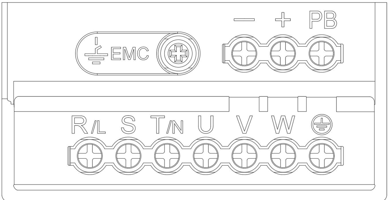
Рисунок 3.1-2 Расположение клемм
