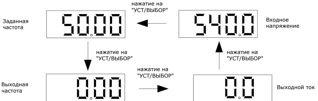
Рисунок 4.2-2 Переключение контролируемых параметров
