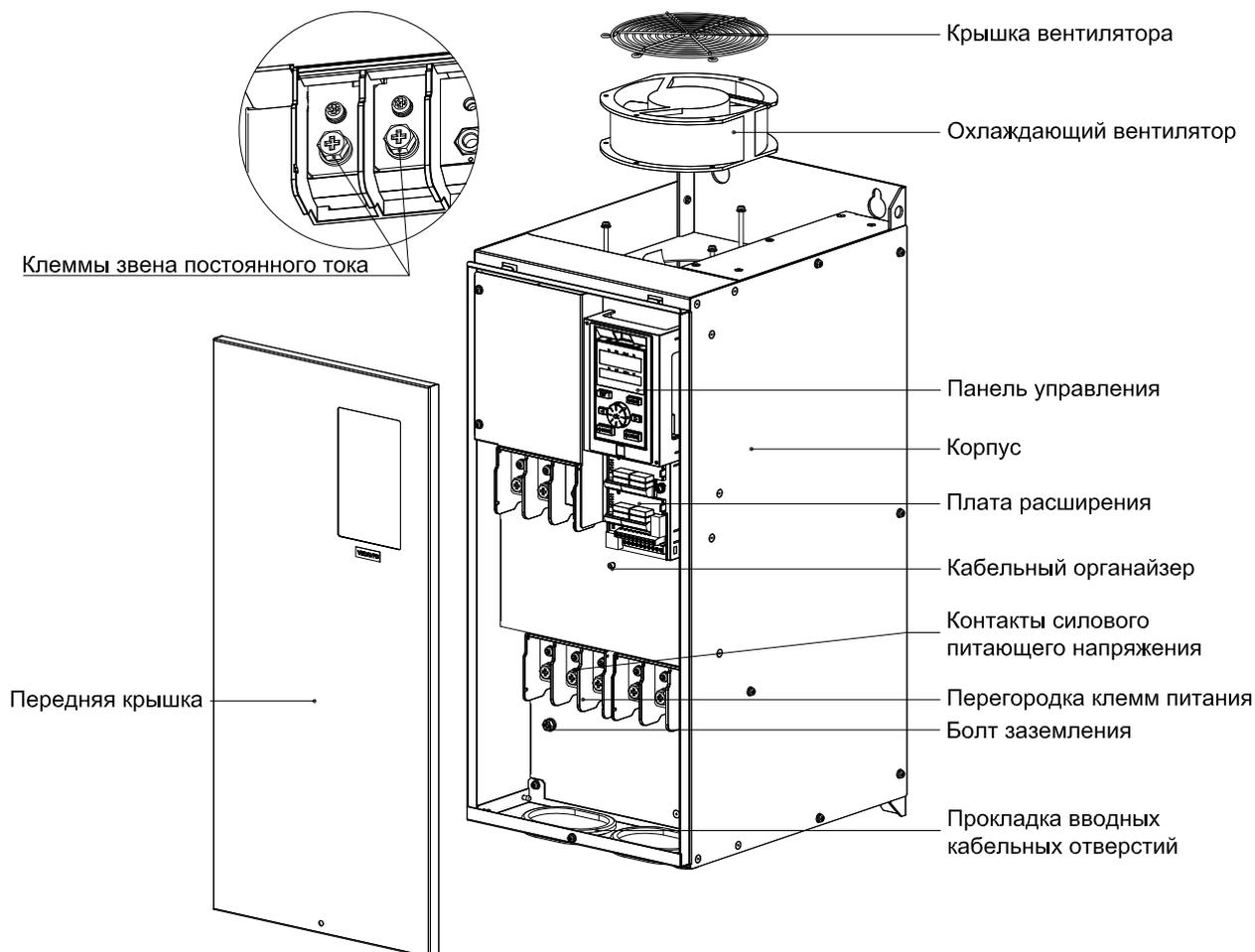
Рисунок 3.1-3 Конструкция преобразователя частоты с металлическим корпусом серии VF-101
