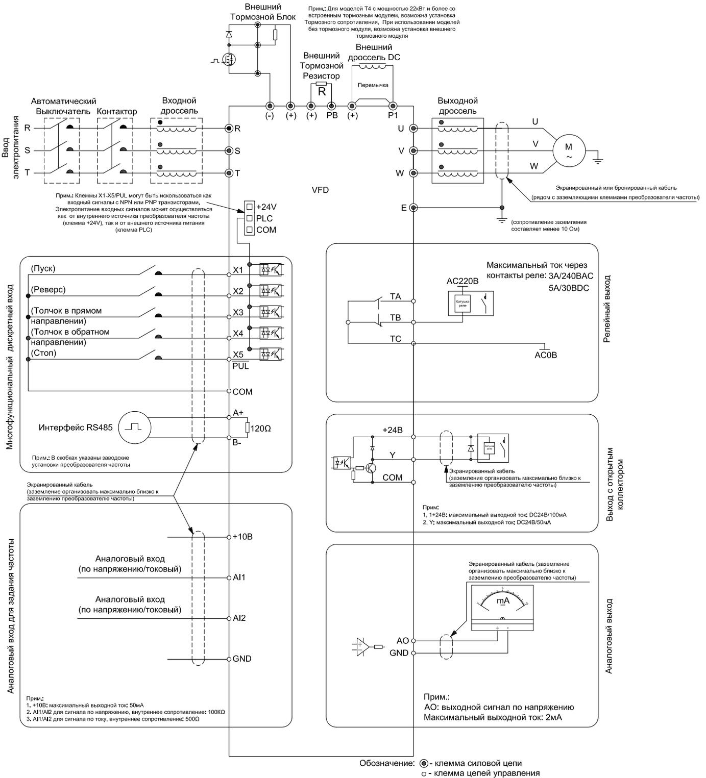
Рисунок 3.2-1 Схема внешних подключений
