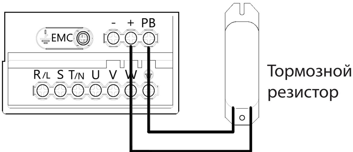
Подключение тормозного резистора для преобразователей частоты мощностью от 30кВт возможно только через внешний тормозной модуль в зависимости от комплектации преобразователя частоты.
