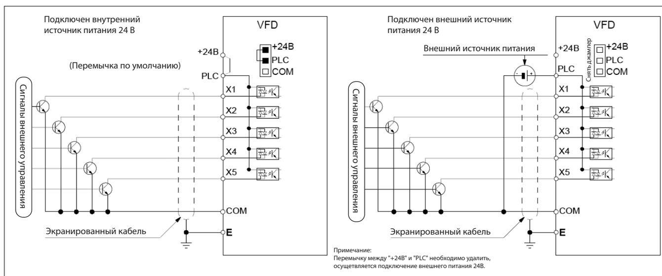
Рисунок 3.6-3 Схема подключения перемычек «+24В», «PLC», «COM»
