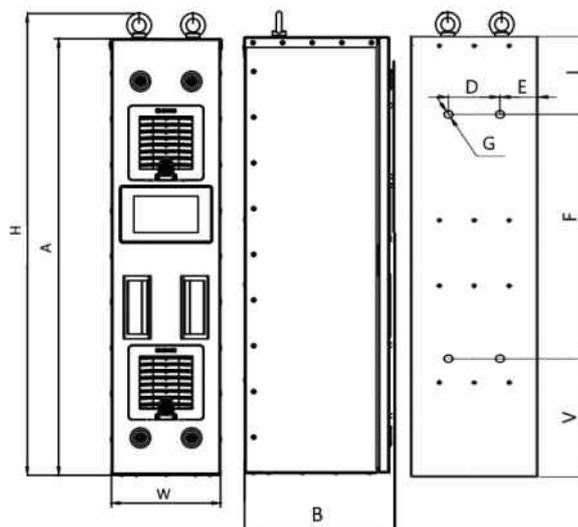
Таблица 5.1-2 Габаритные характеристики преобразователя частоты
