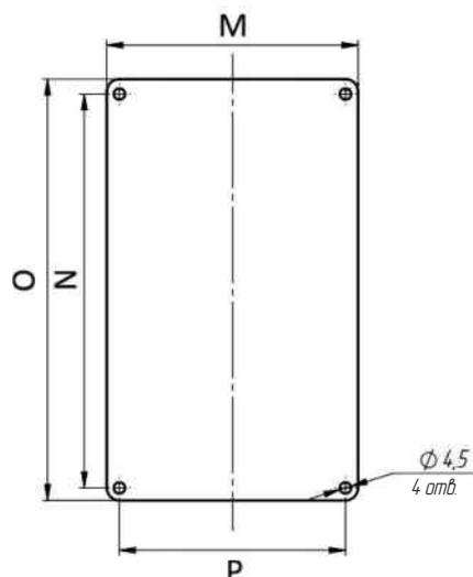
Таблица 2.7-4 Габаритные характеристики нижней крышки преобразователя частоты
