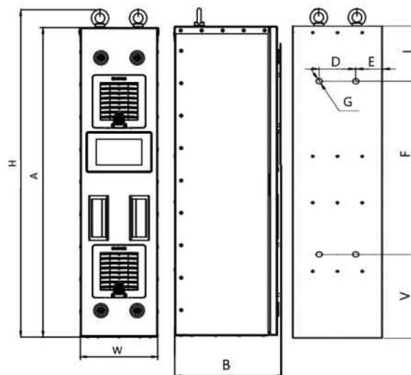
Таблица 2.7-2 Габаритные характеристики преобразователя частоты
