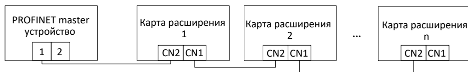
Рис. 4.1 Последовательное соединение шины Profinet
