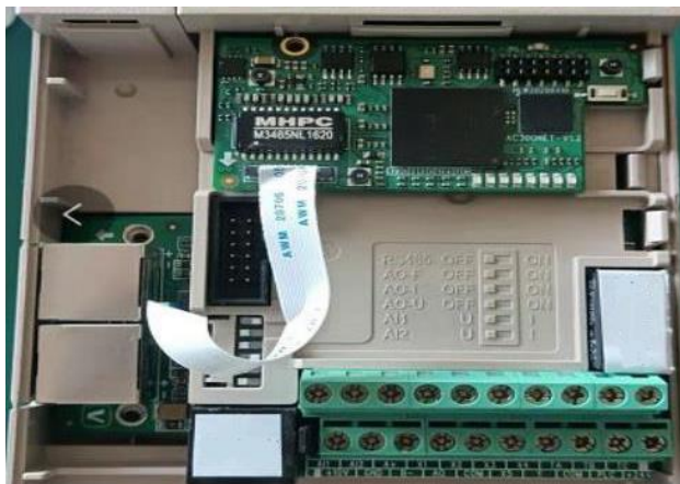
Рис. 7.2 Вариант установки на преобразователях частоты мощностью 2.2кВт-5.5кВт
