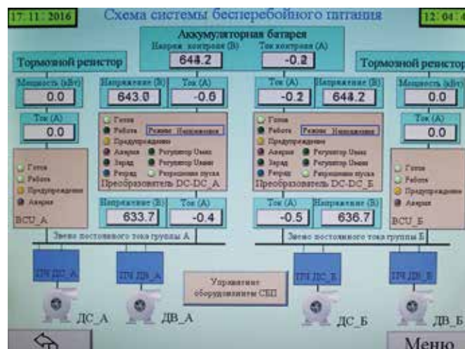
Главный экран панели управления системы бесперебойного питания
