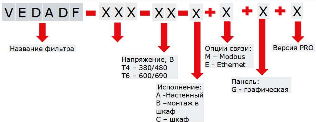
Рисунок 2-1 Расшифровка типового кода VEDADF
