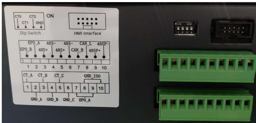
Рисунок 3-14 Dip-переключатель на модуле
