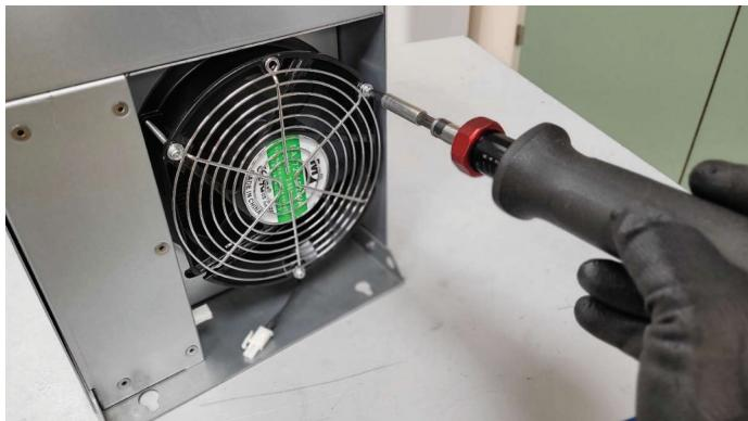
Далее вынимаем вентилятор из его посадочного места.
