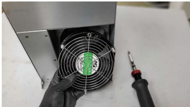
Процесс демонтажа вентилятора завершен.
