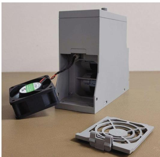
Извлеките кабель питания вентилятора из разъема преобразователя частоты. Нажмите на защелку разъема и удерживая её, аккуратно потяните кабель на себя.
