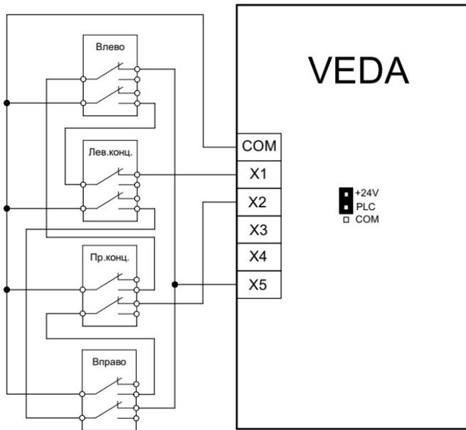
**Данная схема подключения может быть использована только для ПЧ VF-302C или VF-101 и не применима для VF-51.**
