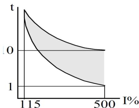
Рис. 8.5 – Кривая работы защиты при перегрузке
