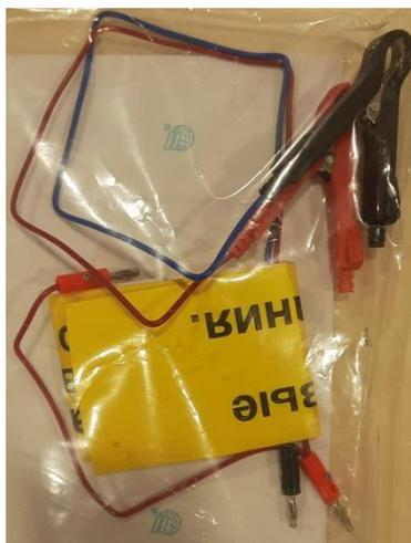
Рис. А.1 – Перемычки для низковольтного тестирования УПП
