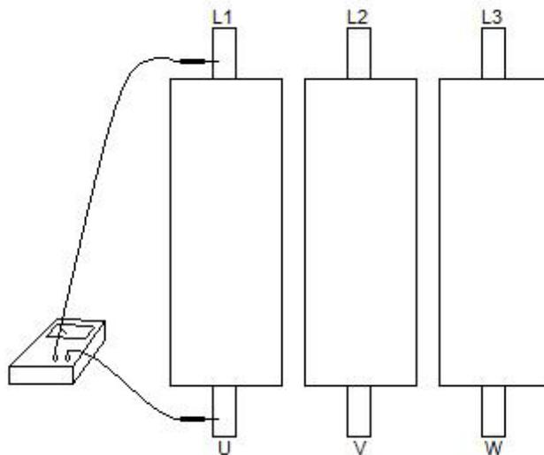
Рис. Б.1 – Измерение сопротивления силового тиристорного блока
