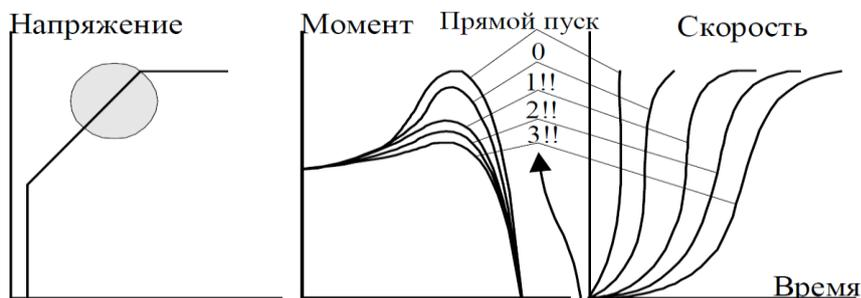
Рис. 8.2 – Кривые пуска (кривые разгона 0, 1, 2, 3 для насоса)
