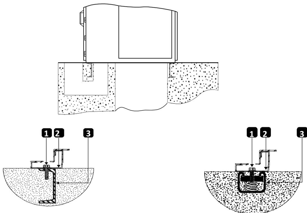
Рис. 6.1 – Монтаж УПП на бетонный пол, где
