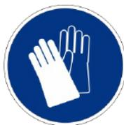
Во время погрузки-разгрузки и технического обслуживания устройства используйте порезоустойчивые перчатки! Существует опасность получения резаных ран.
