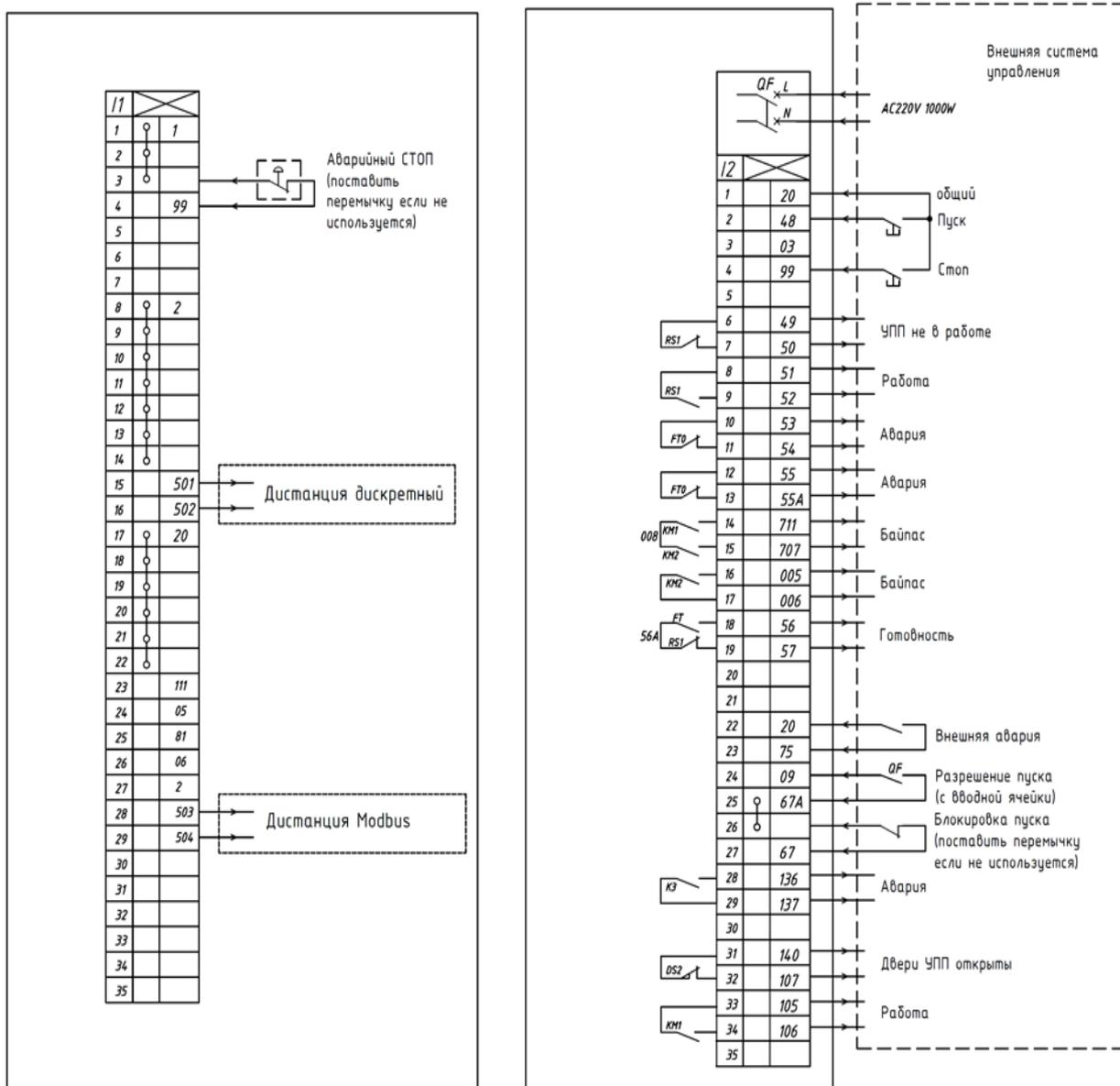
Рис. 7.7 – Клеммы для подключения внешних цепей управления (сигналы могут быть изменены в зависимости от применения!).
