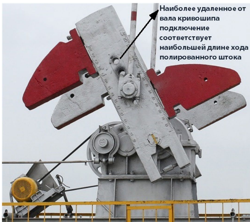
Рисунок 9.7-1 – Зависимость длины хода полированного штока от присоединения шатуна к кривошипу
