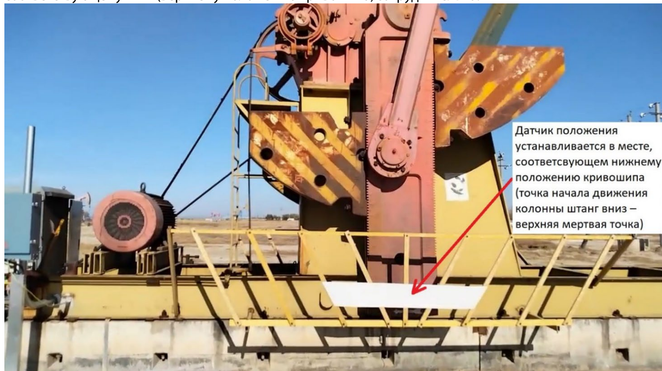
Рисунок 3.4-1 – Место монтажа датчика положения кривошипа
