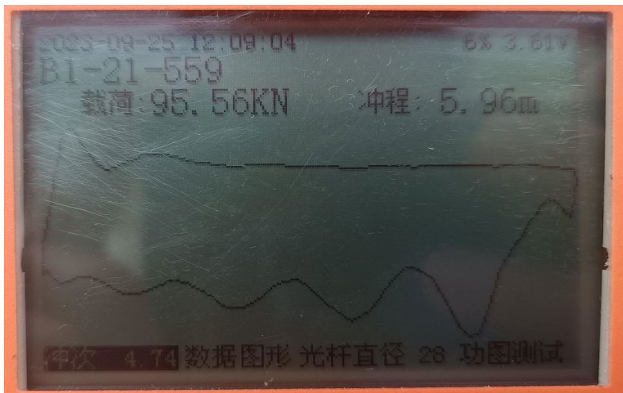
Рисунок 4.4-2 – Динамограмма, измеренная при помощи динамографа для условий, при которых была вычислена динамограмма, представленная на рисунке 4.4-1
