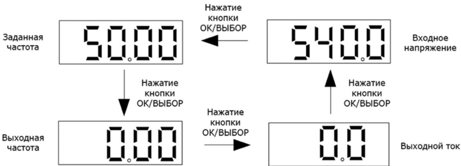
Рис. 7.1-3. Переключение контролируемых параметров
