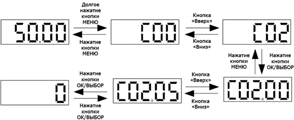
Рис. 7.1-4. Основные операции с панелью управления
