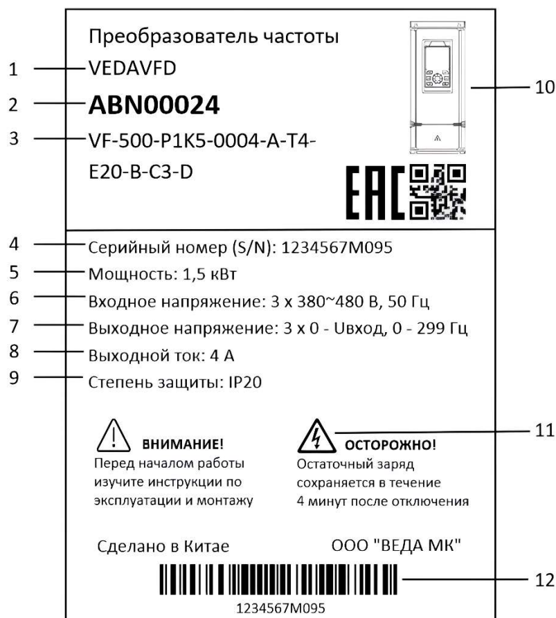
Рисунок 1.3-1 – Пример маркировки преобразователя частоты
