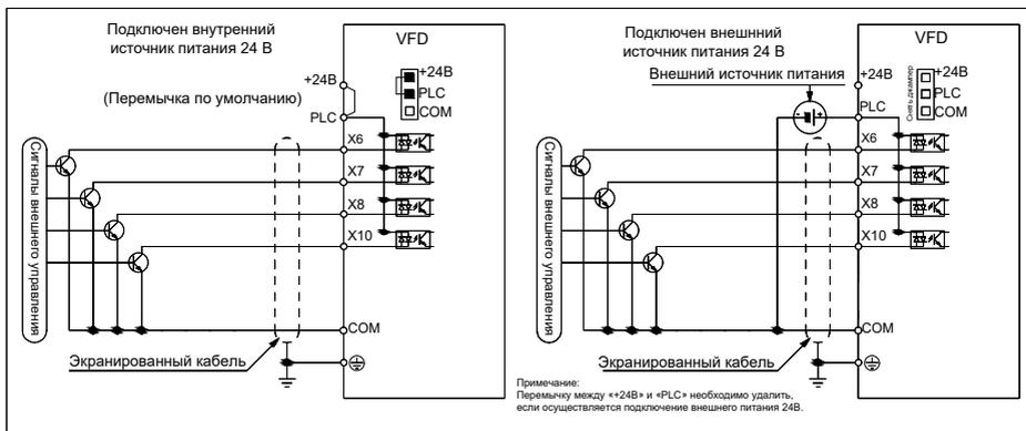
Рис. 2.1.1 Подключение NPN
