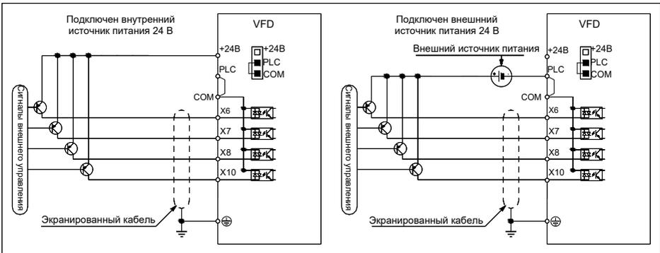
Рис. 2.1.2 Подключение PNP
