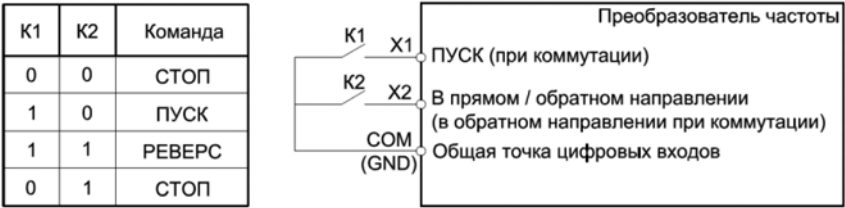
Рисунок 10.9-6. – Двухпроводная схема управления 2
