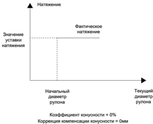
Рисунок 10.20-1. Изменение коэффициента конусности
