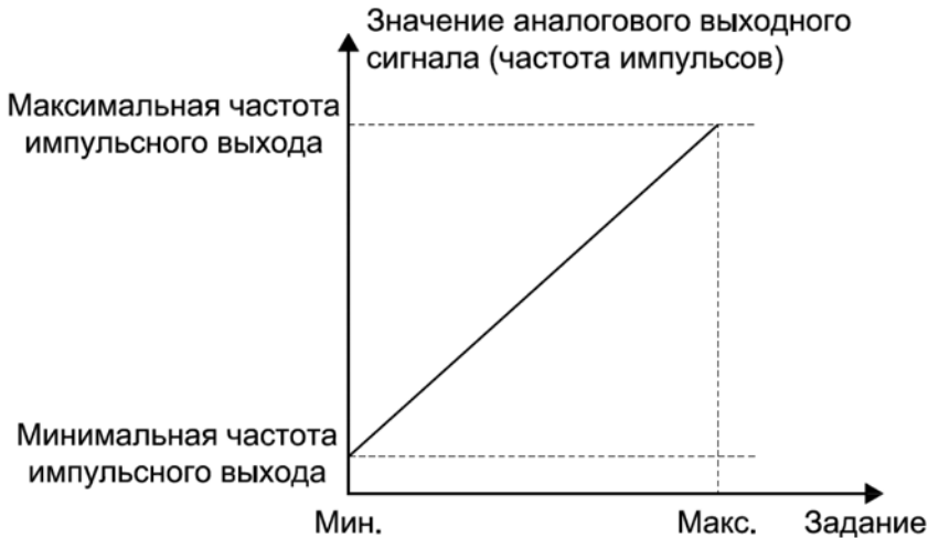
Рисунок 10.10-2. – Амплитудная характеристика импульсного выхода
