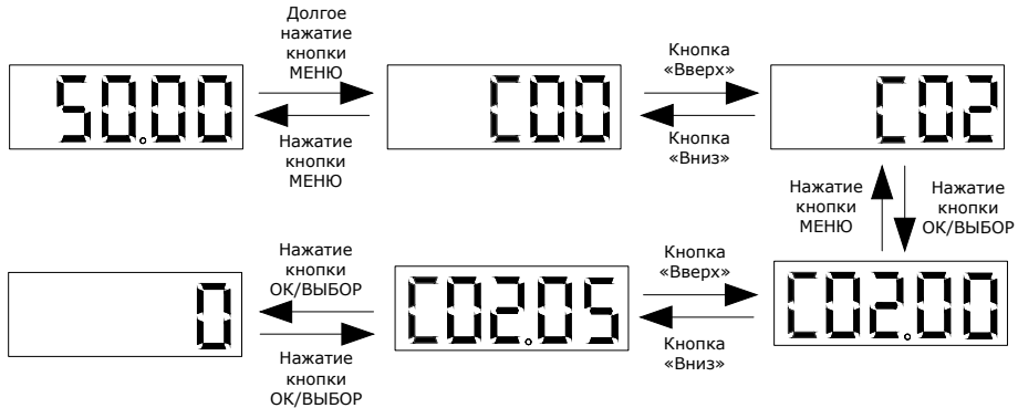
Рисунок 5.5-3 – Основные операции с панелью управления
