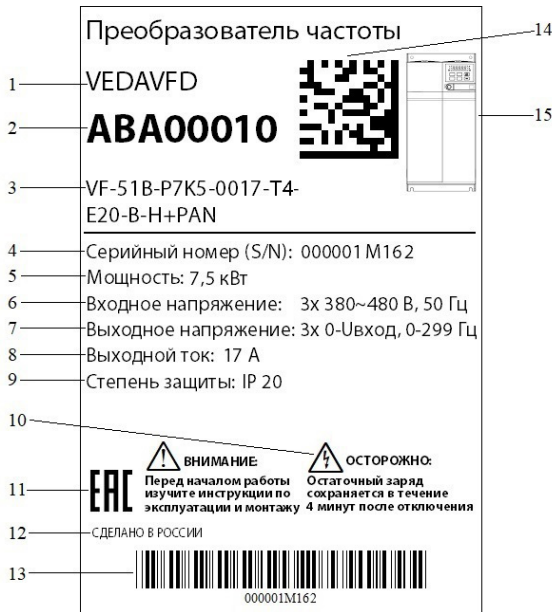
Рисунок 1.3-1 – Пример маркировки преобразователя частоты
