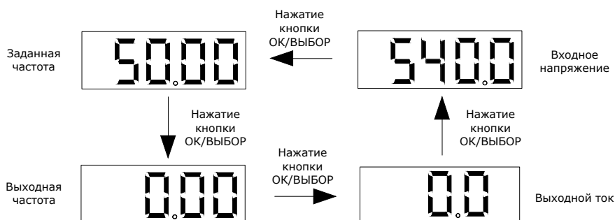
Рисунок 5.5-2 – Переключение контролируемых параметров
