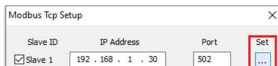
Нажмите «Настройки», чтобы открыть окно «MODBUSTCP config». Согласно руководству к преобразователю частоты VF-101, адрес команды для управления связью дополнительной платы равен 0x3101, поэтому в окно «MODBUSTCP config» добавляется новая команда для запуска кода функции доступа к записи 0x3101.
