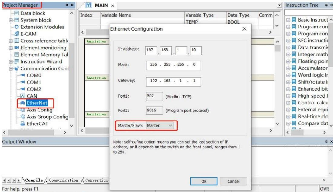
Щелкните правой кнопкой мыши «EtherNet», выберите «Add config table», затем дважды щелкните «EtherNet config», чтобы открыть окно «Modbus Tcp Setup».
