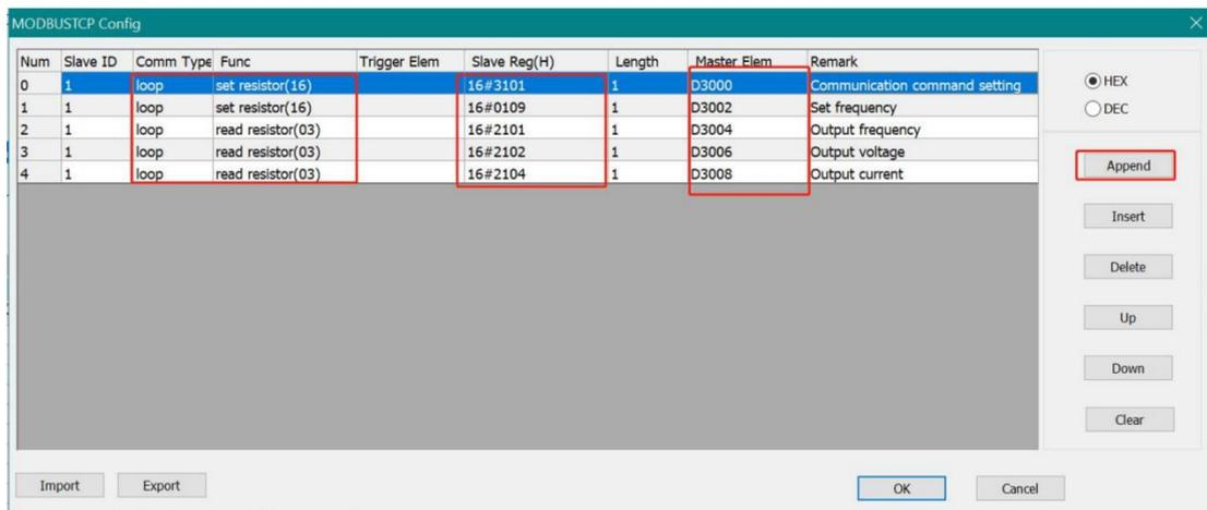
После подключения к PLC необходимо нажать на кнопку Compile (Ctrl+F7) компиляции, чтобы выполнить загрузку, после чего необходимо открыть окно мониторинга Monitor (F9) и добавить переменные M0, D0, D3000, D3002, D3004, D3006, and D3008.
