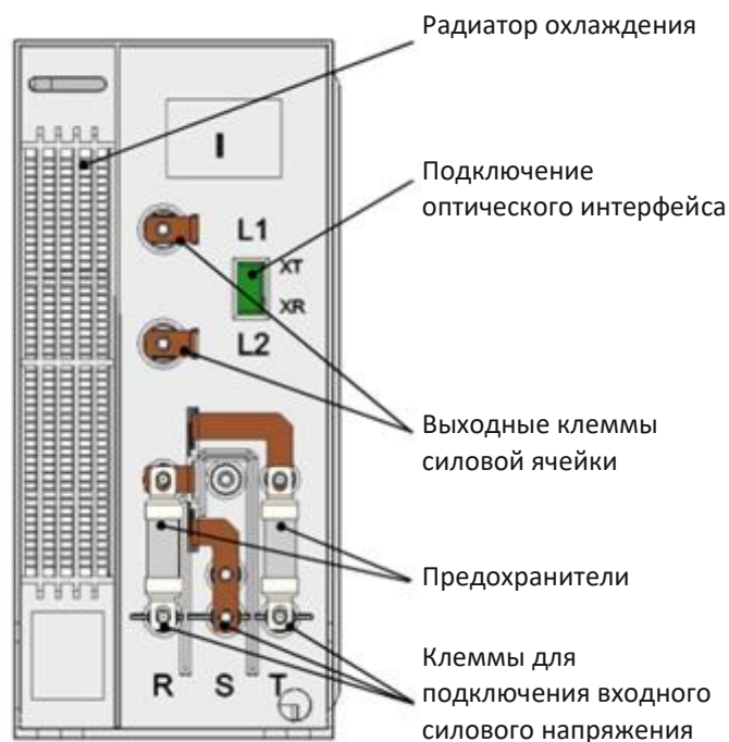
Рис. 1.9 - Внешний вид силовой ячейки с передней стороны
