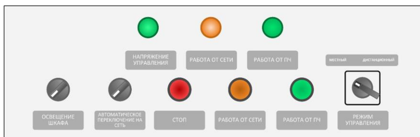
Рис. 6.8 - Панель управления системы автоматического байпаса
