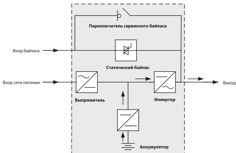
Рисунок 2-5 Схема режима работы от аккумулятора
