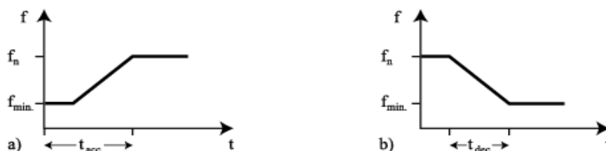
Рис. 3.18 Время разгона и торможения
