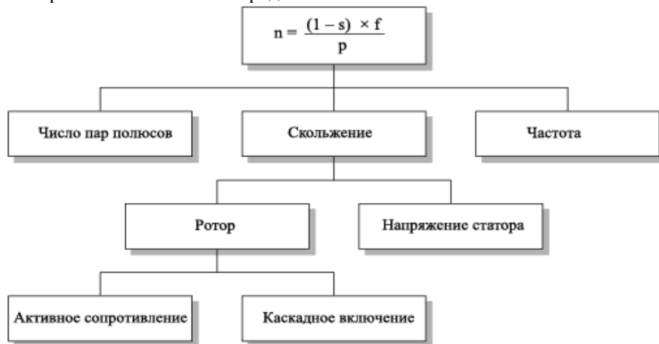
Рис. 1.17 Различные возможности изменения скорости электродвигателя
