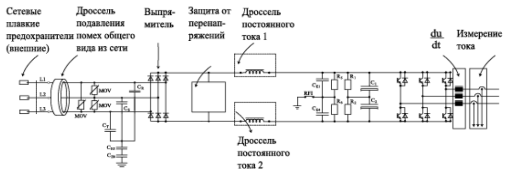
Рис. 4.16. Преобразователи частоты и меры подавления ВЧ-помех
