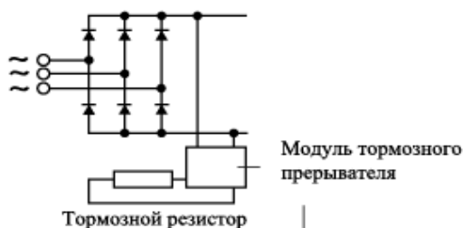
Рис. 3.19. Включение тормозного модуля и тормозного резистора
