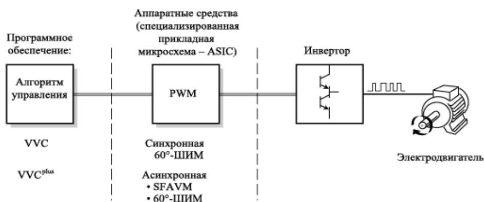
Рис. 2.30 Принципы управления, используемые корпорацией Danfoss
