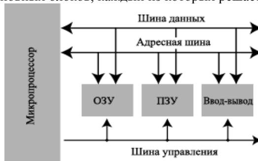
Рис. 2.40. Принципиальная схема микрокомпьютера
