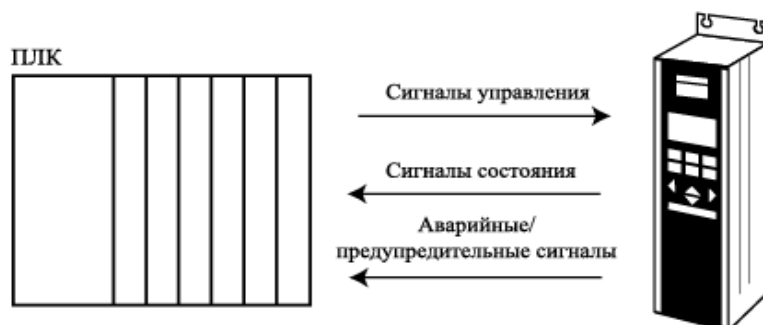
Рис. 2.49. Три типа сигналов между ПЛК и преобразователем частоты
