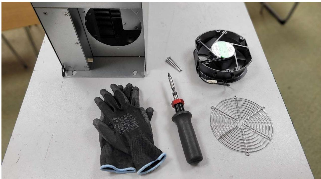
Для установки нового вентилятора охлаждения радиатора следует провести данную процедуру в обратной последовательности.
