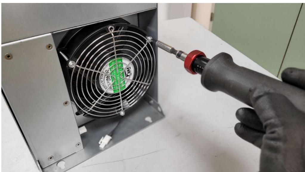
Далее вынимаем вентилятор из его посадочного места.
