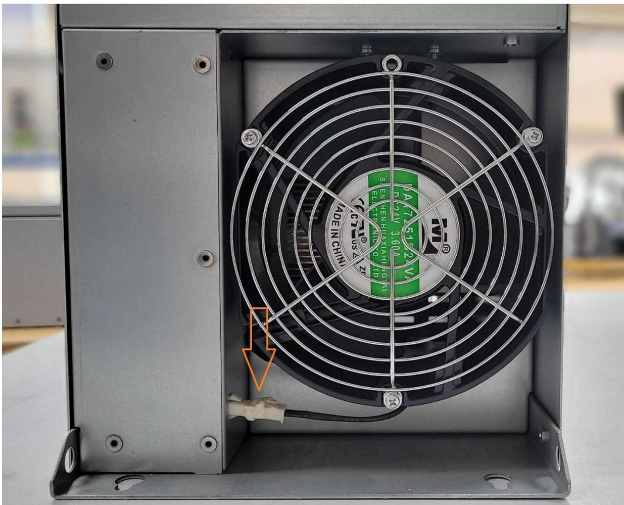
Далее необходимо отсоединить разъем, предварительно нажав на фиксатор разъема
