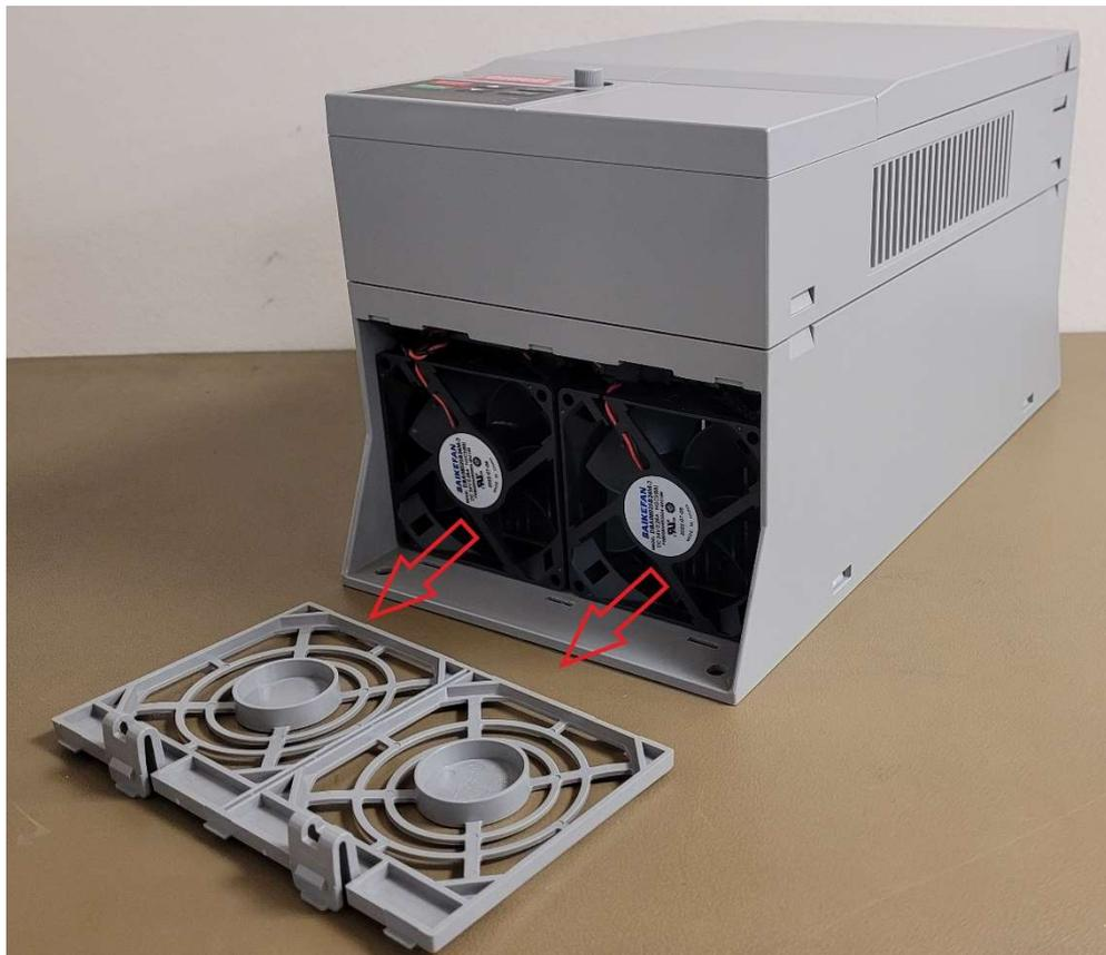
Извлеките кабель питания каждого вентилятора из разъемов преобразователя частоты. Необходимо нажать на защелку разъема и удерживая её, потянуть кабель на себя.
