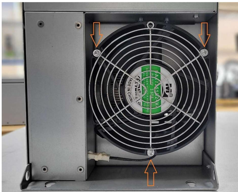
при помощи отвертки (PH2). В процессе откручивания необходимо придерживать вентилятор второй рукой для предотвращения его от падения.
