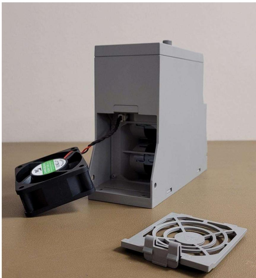
Извлеките кабель питания вентилятора из разъема преобразователя частоты. Нажмите на защелку разъема и удерживая её, аккуратно потяните кабель на себя.
